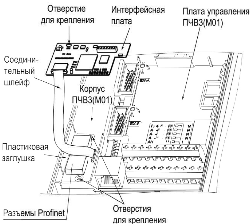
Рисунок 7.21 – Монтаж платы на преобразователях частоты мощностью 5,5 – 45 кВт
