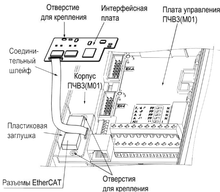
Рисунок 7.24 – Монтаж платы на преобразователях частоты мощностью 5,5 – 45 кВт
