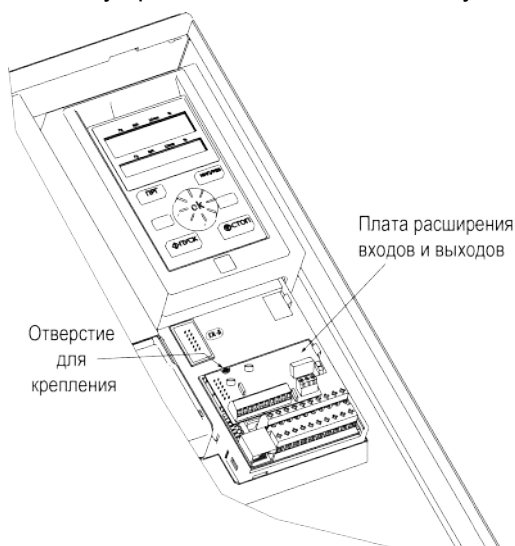
Рисунок 7.30 – Монтаж платы расширения входов и выходов
