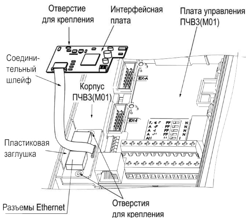
Рисунок 7.27 – Монтаж платы на преобразователях частоты мощностью 5,5 – 45 кВт
