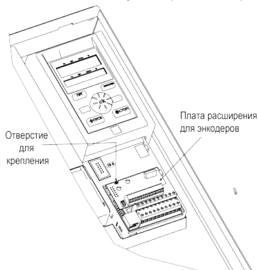
Рисунок 7.31 – Монтаж платы расширения для энкодеров
